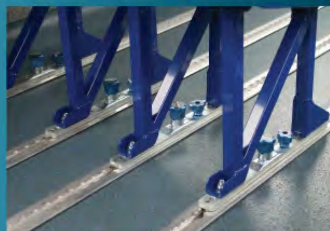
Toutes les fixations de siège sont fournies avec un kit de montage (Q8-7535AS).
